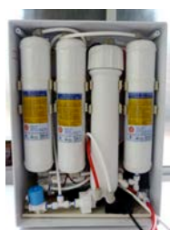
Procédés de filtration, Osmoseurs, adoucisseurs
